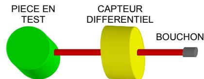
**Test avec zéro central** : test de deux pièces à la fois, une au côté test, l'autre au côté référence.
