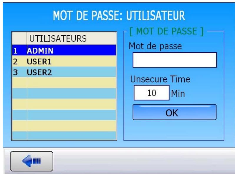
Le paramètre "**Unsecure Time**" est le temps pendant lequel l'accès est possible pour l'utilisateur sélectionné, quand ce temps est passé, le verrouillage s'active et l'utilisateur doit taper à nouveau son mot de passe pour accéder au paramétrage.
