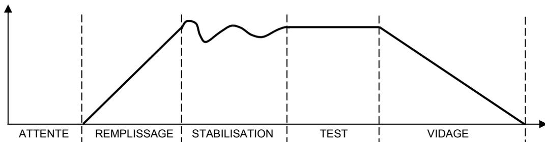
Le cycle de mesure se compose de 5 phases :
