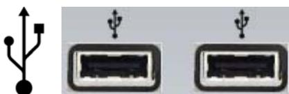
Permet la connexion de divers éléments compatibles **USB** (souris, clavier, clé mémoire etc.)
