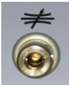
Connecteur rapide pour la vérification de la calibration.
