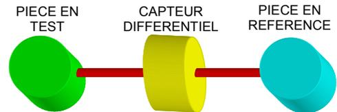
**Test sans référence** : mesure d'une variation de pression entre une pièce test et un bouchon côté référence.
