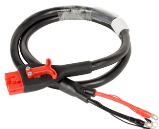
[T1-0309] Câble de sortie d'alimentation BCA - 2 m - 2x16 mm 2 + 2x0,5 mm 2 - GRID GPE80 vers cosse à œillet M8
